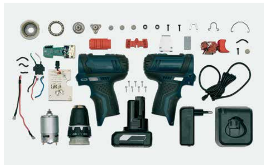
Quatre appareils électriques ont été étudiés à la loupe et démontés jusqu'au moindre composant. La campagne indique ensuite lesquels de ces composants peuvent être réutilisés et explique ce que l'on fait de ceux qui ne peuvent pas être recyclés.
